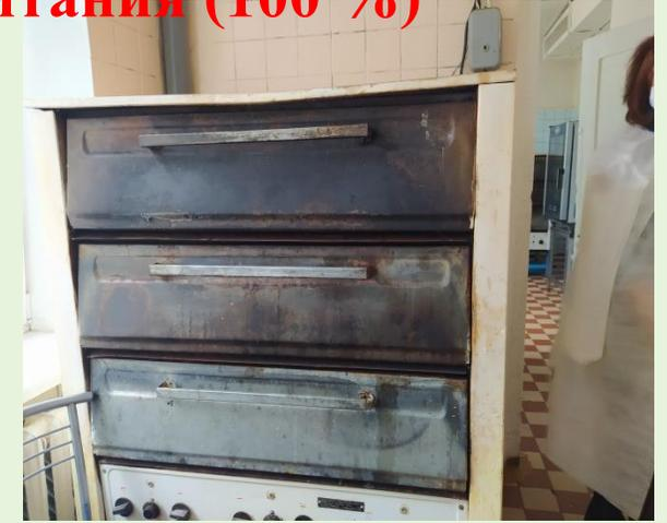
Не обеспечивалось исправное состояние санитарно-технического, торгово-технологического: жарочный шкаф на пищеблоке с поврежденным покрытием.
